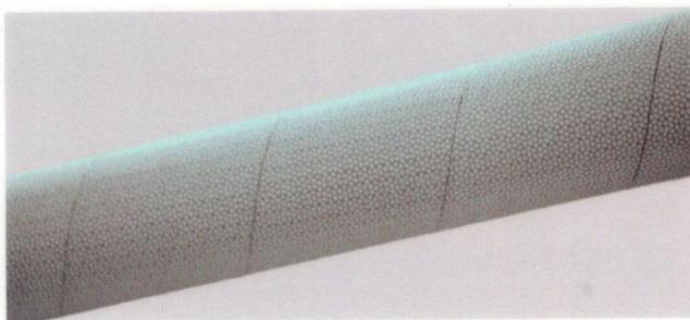
Готовый вал, обмотанный по спирали, с отличным сцеплением и антиадгезионной поверхностью.
