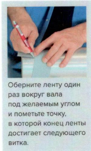
Оберните ленту один раз вокруг вала под желаемым углом и пометьте точку, в которой конец ленты достигает следующего витка.
