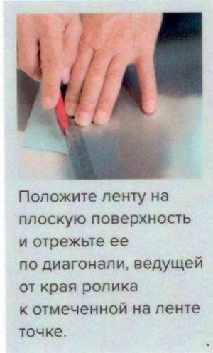
Положите ленту на плоскую поверхность и отрежьте ее по диагонали, ведущей от края ролика к отмеченной на ленте точке.
